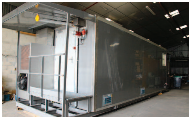
Shelter de contrôle commande d'une installation industrielle ATEX
