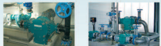
Le Multichopper Börger est un broyeur à grille et à couteaux. Les 3 couteaux assurent une coupe idéale à chaque rotation.
