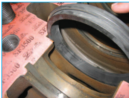
Une bague en matériau composite DuPont Vespel CR-6100 en cours de montage
