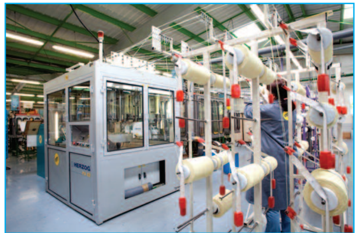
Au cœur de la fabrication des tresses (la machine elle-même est dans la cabine insonorisée)
