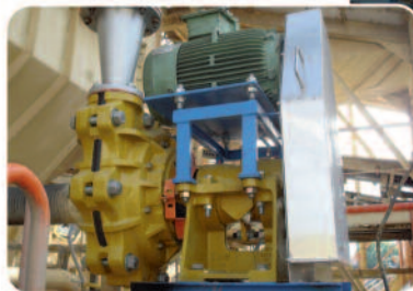
EMW-R : Pompe à blindage caoutchouc
