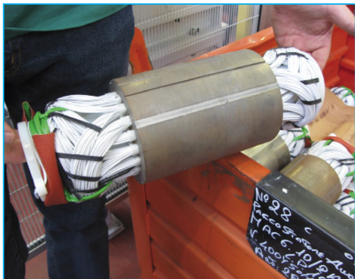
Les stators des moteurs immergés sont fabriqués sur place.
