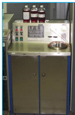
L'IFTS, organisateur du séminaire sur le contrôle des particules en suspension, dispose d'un banc d'étalonnage de compteurs de particules.
