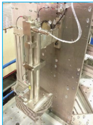
Préparation pour test sismique sur table vibrante d'un ensemble ALM (Accident Level Measurement) pour centrale nucléaire.
