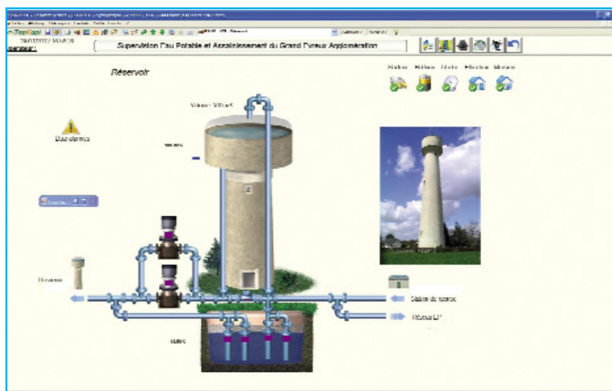
Supervision d'un château d'eau
