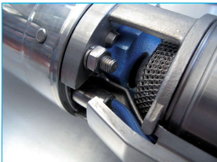
En bleu, le nouveau dispositif de protection galvanique DEFENDER© monté en standard sur plusieurs types de pompes CAPRARI.
