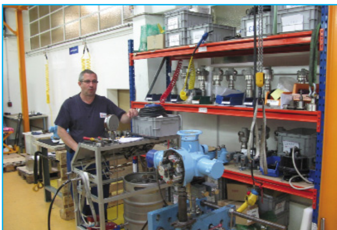
Vanne en cours de test sur un autre poste de montage.
