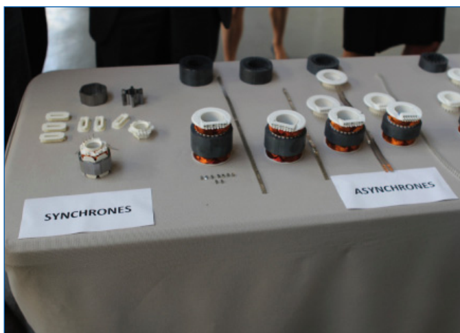
Les nouveaux moteurs synchrones sont nettement plus compacts et permettent des économies d'énergies substantielles
