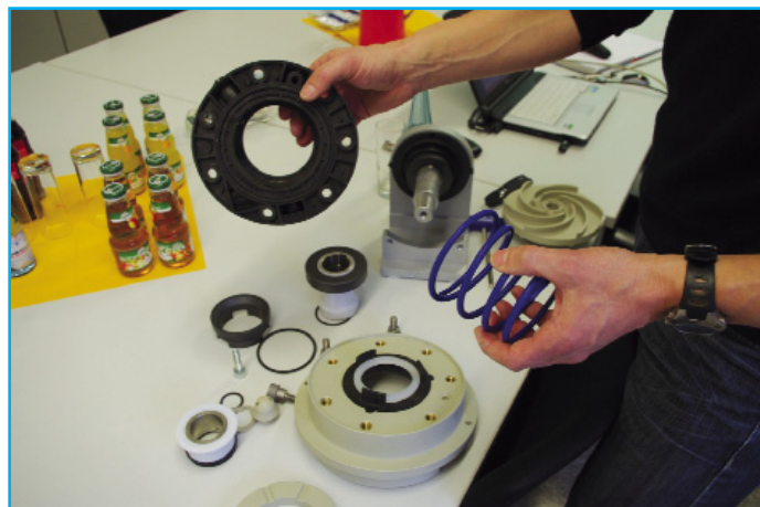
La garniture mécanique « maison » des pompes Munsch est un jeu d'enfant à monter. De nombreux détrompeurs empêchent toute erreur de montage.
