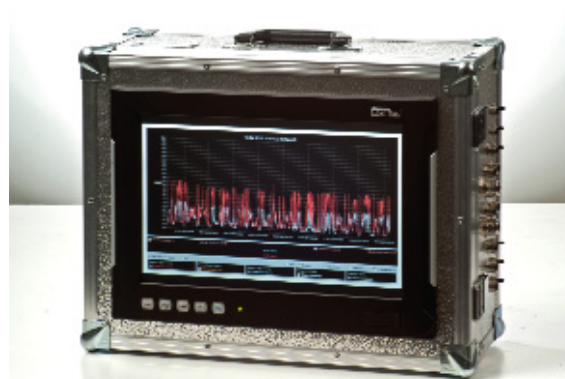
Un diagramme de relevé des données de pression (aspiration et refoulement) des 3 pompes analysées dans une usine d'aluminium.
