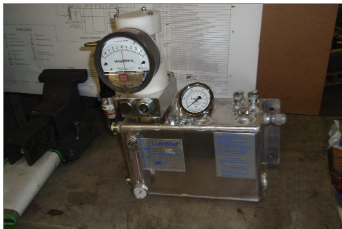
Générateur de brouillard d'huile pour 1 à 2 pompes ou machines tournantes, pas plus gros qu'une boîte à chaussure
