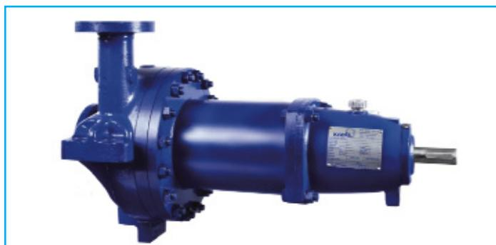
Cette pompe monocellulaire horizontale à étanchéité absolue est une pompe à plan de joint radial ce qui facilite sa maintenance et est équipé d'un entraînement magnétique éliminant tout risque de fuite du produit pompé vers l'atmosphère.
