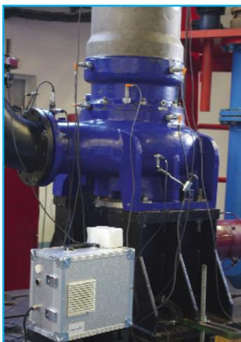
Mesures de vibrations lors de l'essai d'une pompe
