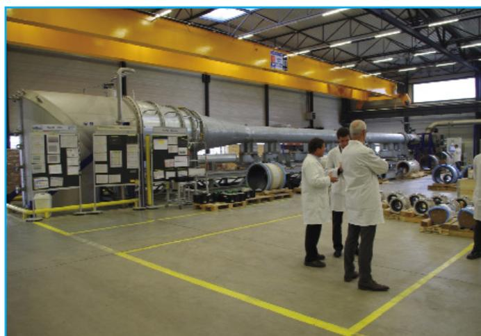
*Installation d'essai de débitmètres jusqu'à 2 mètres de diamètre*
