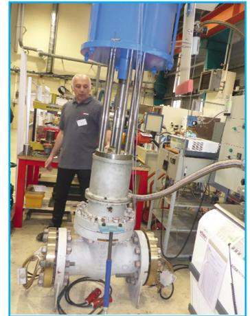
Essai d'un actionneur
