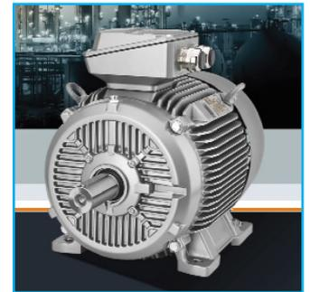
Cette nouvelle gamme de moteurs antidéflagrants se décline en deux séries : la Basic Line 1MB15 et la Performance Line 1MB16, cette dernière étant destinée à l'industrie de process du fait de ses paliers renforcés et d'une protection moteur par thermistance. Les moteurs sont disponibles en versions Ex t (protection contre les explosions dues aux poussières) et Ex nA (anti-étincelle). Ils peuvent ainsi être utilisés en version ATEX zone 2 pour les gaz, et en zones 21 et 22 pour les poussières.
