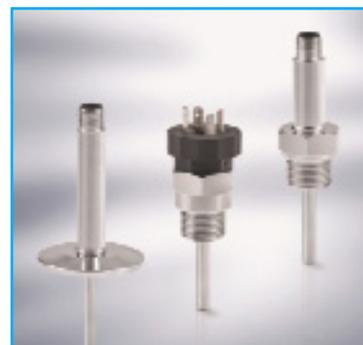
Bien qu'elles répondent à différents domaines d'application, les OPTITEMP partagent le même concept de base : dotées d'un élément sonde Pt100 de classe A et d'un transmetteur analogique intégré, elles couvrent une gamme de température de -50 à +150°C (jusqu'à +200°C sans transmetteur intégré). La précision est de  $\pm 0,15\%$  de la plage de mesure, préconfigurée pour une sortie 4... 20 mA.
