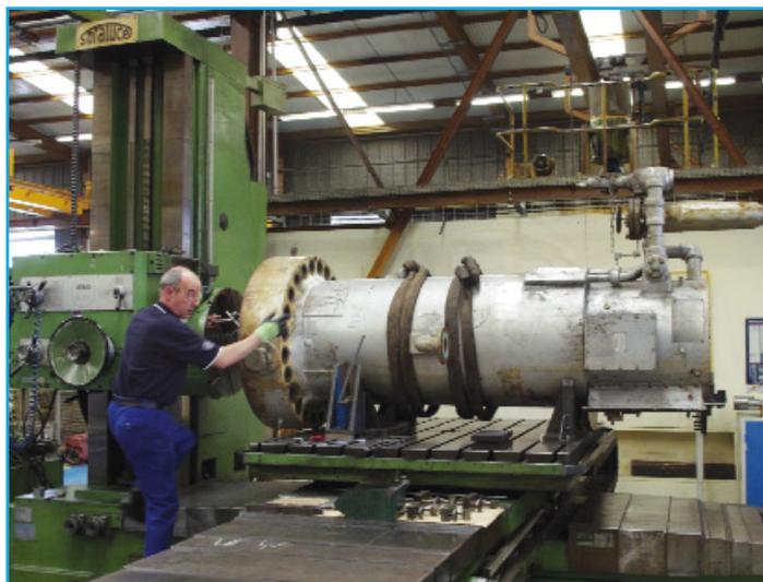
Usinage d'un corps de pompe pour réseaux de chaleur
