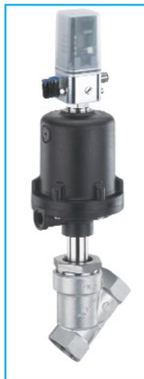
La vanne de régulation GEMÜ 554 est une vanne à clapet à siège incliné. La forme conique du clapet a été conçue pour répondre aux applications de régulation de liquides et de gaz neutres ou agressifs. La température des fluides peut aller de -10 °C jusqu'à +180°C avec une viscosité maximale de 600 mm<sup>2</sup>/s pour une pression de 25 bar.
