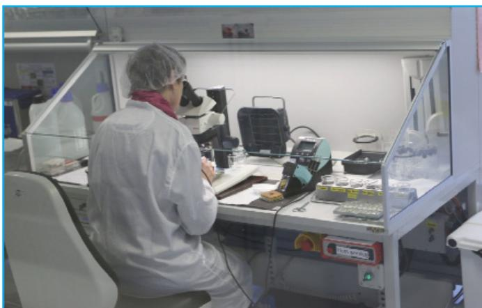
*De très nombreux composants électroniques sont fabriqués et assemblés sur place. Ici poste d'assemblage des têtes de mesure des analyseurs de gaz*
