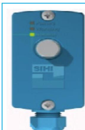
Le SIHIdetect apporte de l'intelligence aux pompes Sterling SIHI : des capteurs de vibrations y sont associés à un microprocesseur pour délivrer par SMS des messages d'alerte sur tous les dysfonctionnements des pompes : cavitation, usure des roulements, désynchronisation de l'entraînement magnétique, débit anormal,...
