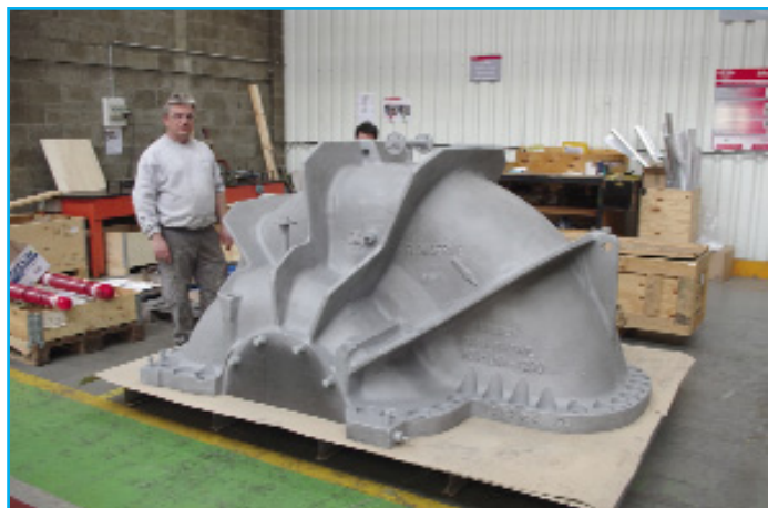
Un autre exemple de réalisation très particulière : le corps supérieur de pompe pour une plate-forme offshore vient d'être revêtu d'une peinture de haute qualité spéciale marine.
