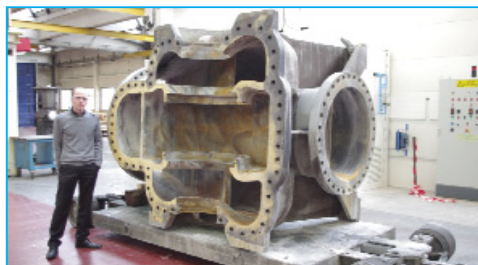
Corps d'une pompe de 20 000 m 3 /h pour une plate-forme pétrolière
