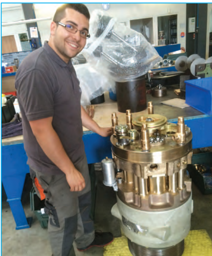
Compresseur à barillet en fin de montage. Sur la magnifique pièce de fonderie en bronze d'alu, on distingue les emplacements des pistons, des échangeurs thermiques (qui doivent tenir 30 ans à l'eau de mer) et des soupapes de sûreté.
