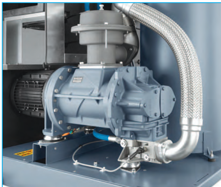
Cela pourrait être un compresseur, mais c'est une pompe à vide. Voir page 57...
