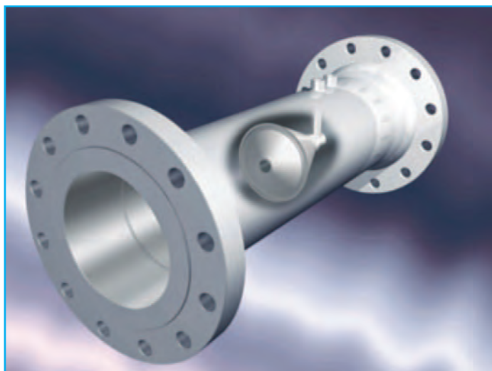
Le V-Cone, une technologie insensible à la présence de liquide dans les gaz. Il ne nécessite en outre qu'une longueur droite de 3 fois son diamètre en amont pour fonctionner correctement
