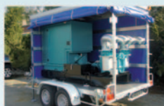
Groupe électro-pompe sur châssis mobile ou sur remorque avec commande électrique (ATEX) ou thermique (Débit 500 m 3 /h).
