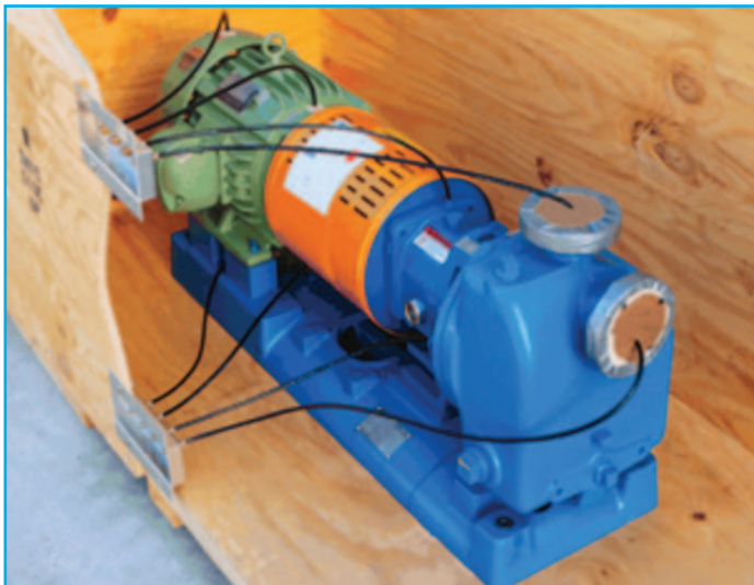
Une pompe protégée par brouillard d'huile dans son emballage : une quasi recommandation de l'API pour les stockages supérieurs à 6 mois !
