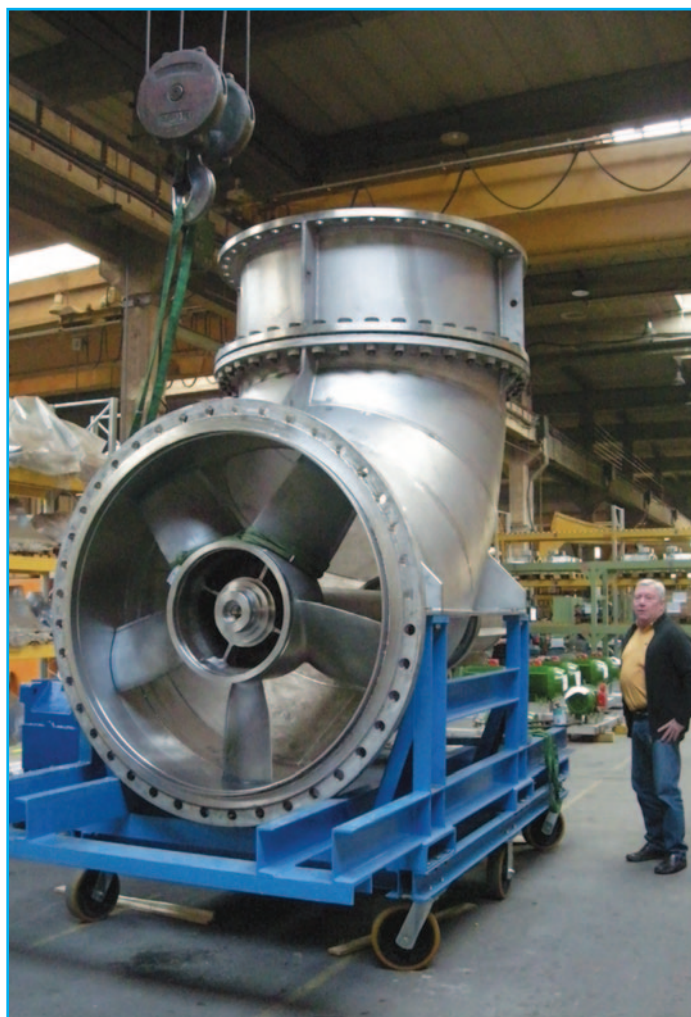
Pompe axiale basse pression en fin de fabrication
