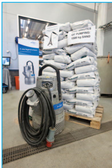
De l'eau et 1,5 tonne de sable pompés en 2 mn
