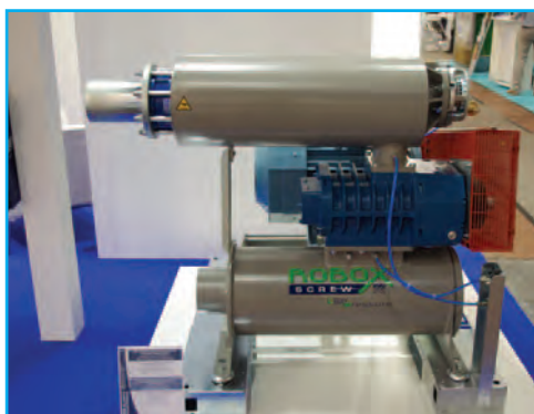
Le Robox tel qu'il a été présenté sur Pollutec (sans son capot insonorisant) montre bien la simplicité de sa conception
