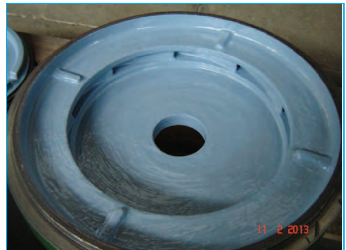
Application de Belzona 1341 (Supermetalglide)
