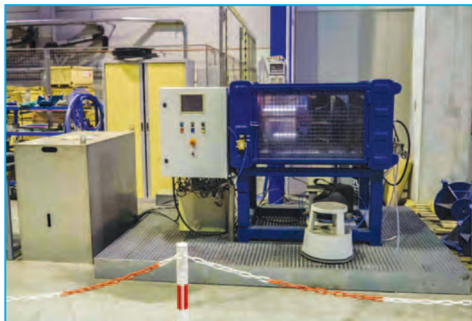
Le banc d'essais peut tester des vannes jusqu'au DN600
