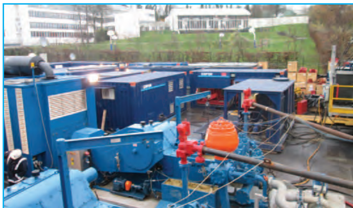
De nombreuses pompes et groupes motopompes sont nécessaires lors de ce type de forage.
