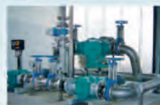
Le Multichopper Börger est un broyeur à grille et à couteaux. Les 3 couteaux assurent une coupe idéale à chaque rotation.
