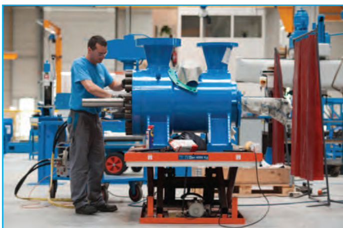
Montage final d'une pompe rénovée
