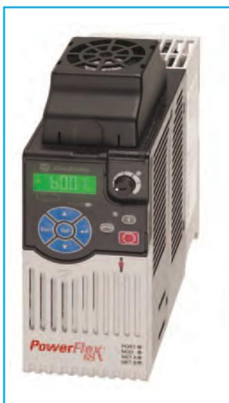
Premier de la nouvelle génération de variateurs compacts de Rockwell Automation, le variateur de vitesse c.a. PowerFlex 525 bénéficie d'une conception modulaire dans des gammes de puissance de 0,4 à 22 kilowatts avec des tensions d'entrée de 100 à 600 volts. Ses caractéristiques de connectivité Ethernet/IP™ intégrée, de sécurité, de programmation USB et d'économie d'énergie, ainsi que diverses options de commande moteur lui permet de s'intégrer à des machines autonomes ou à un système simple.
