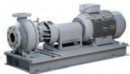
Dimensionnées pour une pression au refoulement jusqu'à PN40, les HPK-L peuvent fonctionner à une température de service pouvant atteindre 400 °C sans nécessiter de dispositif de refroidissement supplémentaire, grâce à une barrière thermique largement dimensionnée et un ventilateur positionné en bout d'arbre.
