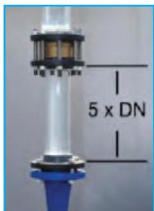
De nombreuses séries de mesures sur un banc d'essai KSB ont été effectuées pour définir quel type de robinet de non-retour – à savoir clapet à double battant ou clapet à soupape – se prête le mieux à quel type d'application.
