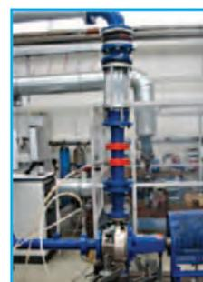
*Maquette d'essai pour l'analyse du comportement de clapets de non-retour associés à des pompes à vitesse variable*
