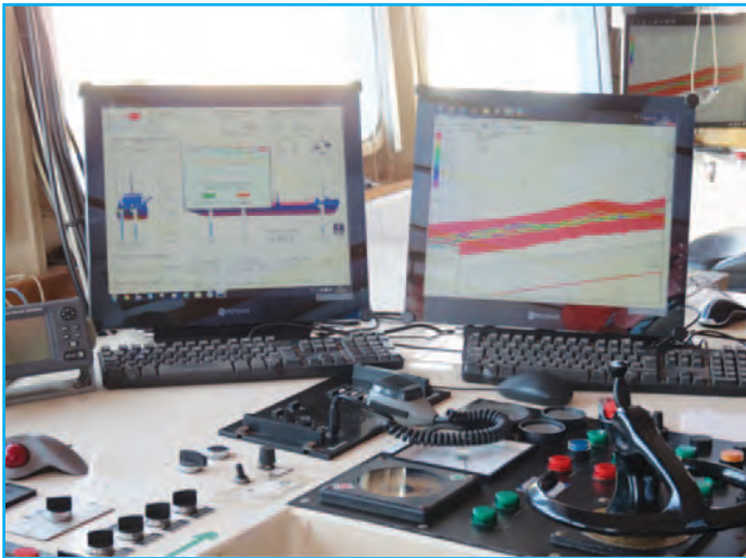
Au poste de conduite de la drague, on pilote au GPS. Par ailleurs, un logiciel contrôle l'équilibre du navire et un autre suit le dragage en temps réel.
