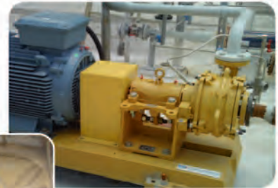
/ EMW-M : Pompe blindée métallique
