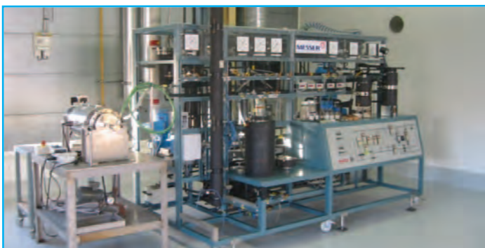
Unité pilote pour la mise au point de procédés au CO 2 supercritique
