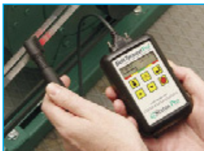
Fig e : Système de mesure de tension de courroie
