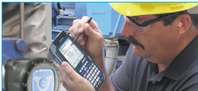
Le recueil sur les vibrations permet la détection précoce des problèmes dans les plages de fréquences basse, moyenne et haute.
