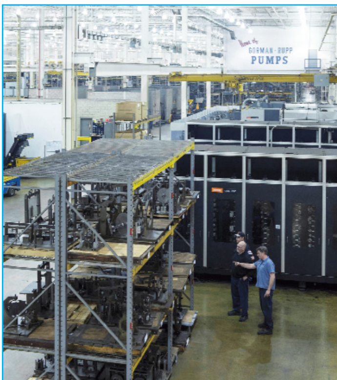
Des machines-outils avec, en avant-plan, des supports pour les pièces à usiner.
