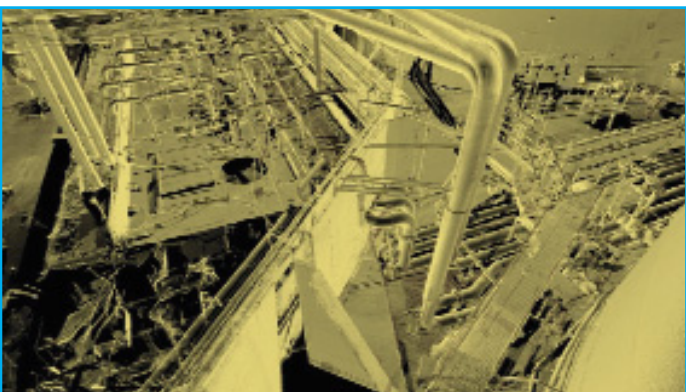
Image en 3D issue du scanning dite aussi scanning brut (nuage de points)
