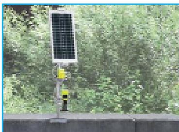
Le module de transmission Plicsmobile T61 de VEGA alimenté par une batterie et un panneau solaire permet d'obtenir une solution entièrement autonome en association avec le capteur de niveau radar Vegapul S61. Le module
