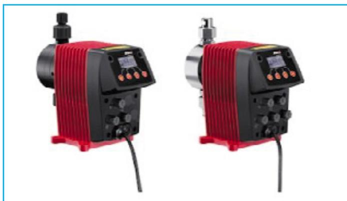
Les débits de ces pompes distribuées par Techniques Des Fluides couvrent une gamme de 0.5 à 15 l/h avec des pressions jusqu'à 16 bars. Des clapets à double billes leur assurent un dosage précis. La cadence des pompes MAGDOS LK peut être ajustée manuellement ou au moyen de contacts de contrôle externes pour adapter la capacité de dosage, tandis que la cadence des pompes Magdos LP peut aussi être ajustée via un signal 0/4...20 mA.
