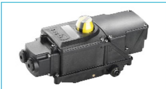
L'interface VDI/VDE entre le positionneur et l'actionneur permet le montage direct sur les actionneurs 1/4 de tour de la gamme KSB Actair et Dynactair - une solution simple et économique supprimant les pièces d'adaptation et le tuyautage pneumatique externe. De plus, le nombre de sources d'erreur éventuelles et le risque de fuites d'air comprimé sont réduits considérablement.
